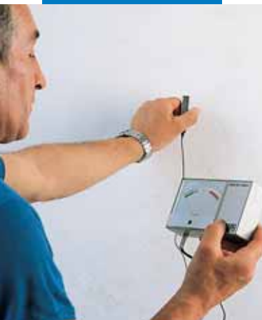
Feuchtemessung des Putzuntergrundes
